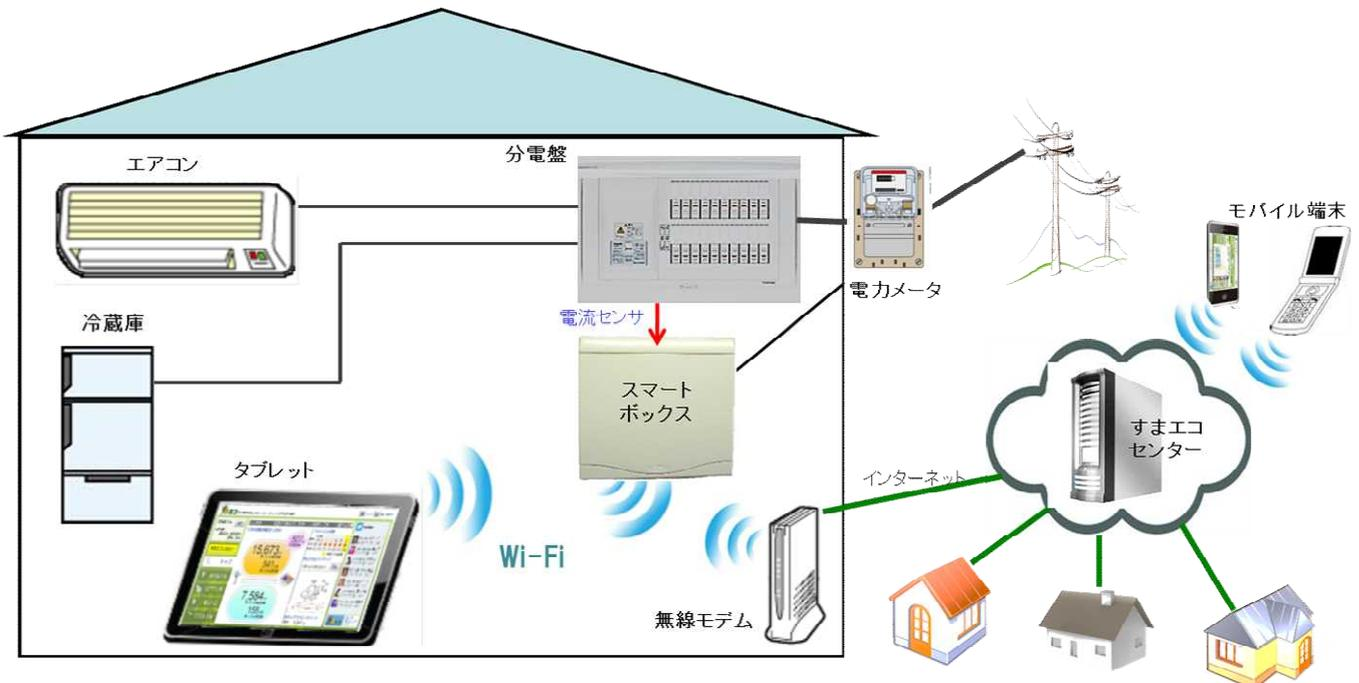
スマートボックス：分電盤の電気情報を計測し、インターネットを介してすまエコセンターへ情報を送信する機器です。
