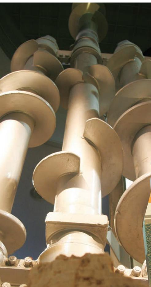
三軸オーガー(巨大ドリル)で琉球石灰岩に穴を掘り、コンクリートを流し込み水を止める壁を造る。(地下ダム資料館模型)
