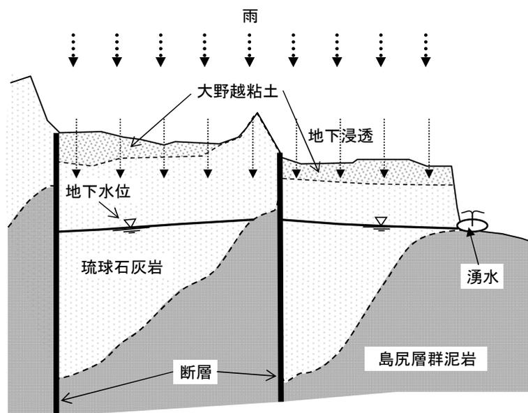
図1-1 宮古島に地下水がたまる仕組み
